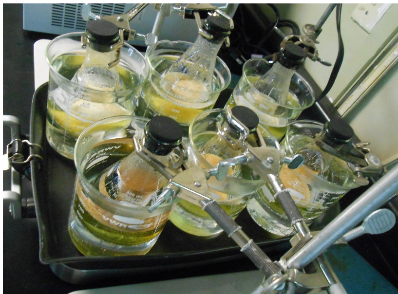
Figura 24. Montaje para la determinación del porcentaje de Holocelulosa.
