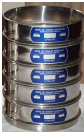
Figura 14. Tamizado de biomasa, tamiz N° 35.
